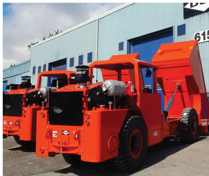
DUX DT-12N (узкопрофильная версия самосвала) шириной 1 625 мм
